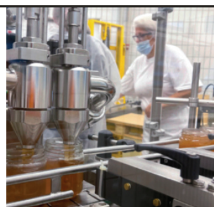
Einer von wenigen maschinellen Schritten: das Abfüllen der Konfitüre in die Gläser
